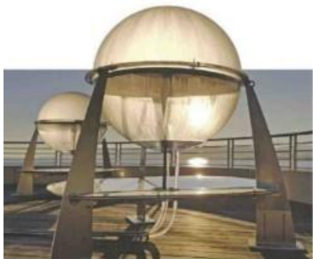
Créés par HelloWater, les modules Hello utilisent la distillation solaire. Par effet de serre, l'eau se condense, ruisselle sur les parois et est récupérée, les résidus solides restent à l'intérieur.
